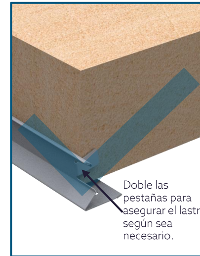
Doble las lengüetas en los extremos del riel. (Consulte el punto 5.2 para determinar si es necesario)
